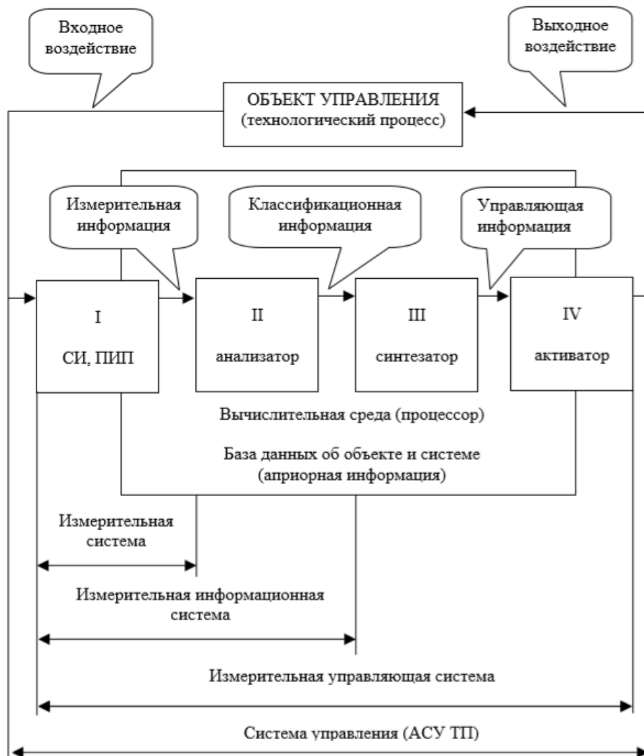
Рисунок 1 - Упрощенная структура ИИС и АСУ ТП
